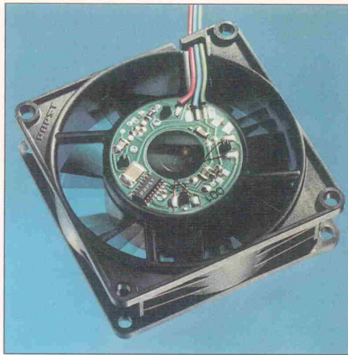
Bild 1. Das kundenspezifische IC ermöglicht die Unterbringung der gesamten Elektronik auch im kleinsten Lüfter.
